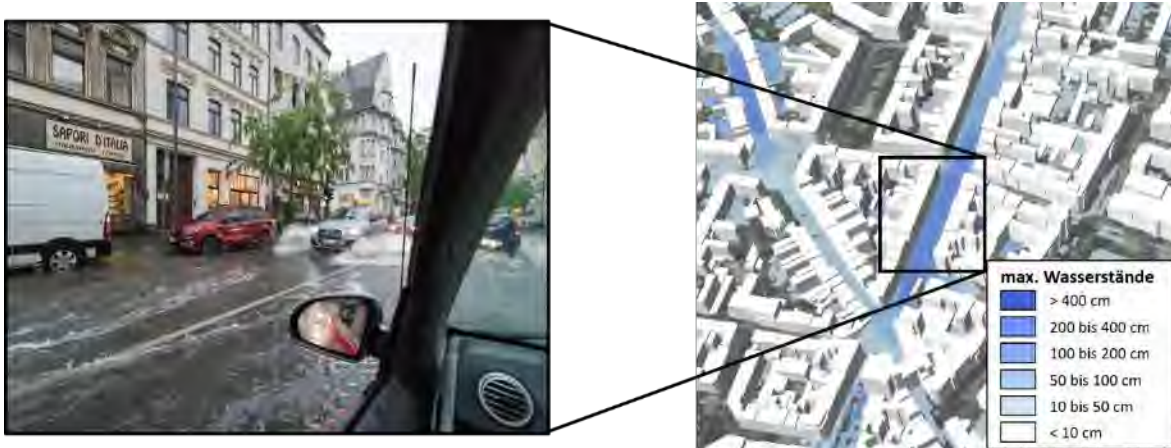
Abbildung 3: Dreidimensionale Simulation eines Starkregenereignisses
