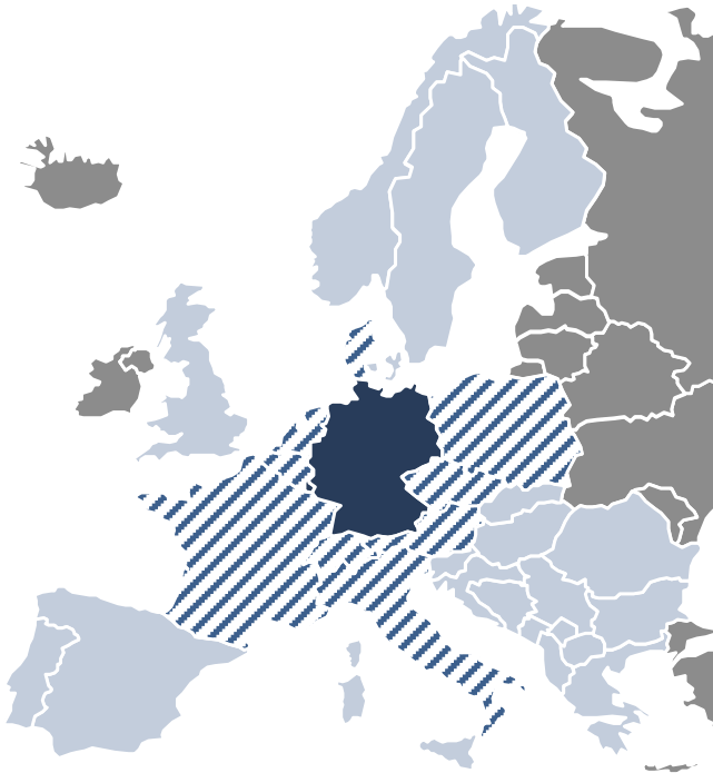
Abbildung 10 Detailgrad der Netzmodellierung: Fokusregion (blau) und angrenzende Länder (schraffiert) auf Übertragungsnetzebene netzknotenscharf; weitere Länder des Synchronverbundes (hellgrau) über vereinfachte Darstellung der Netzinfrastruktur. (Quelle: Consentec, FfE, IER)
